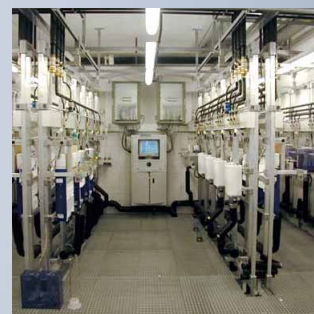
32 teljesen automatizált öblítőtartály tesztállvány
